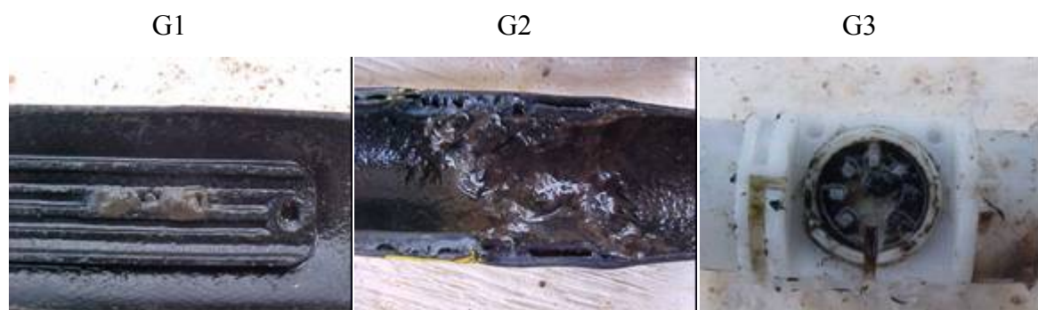
Figura 1 - Gotejadores G1, G2 e G3 com formação de biofilme em suas pequenas aberturas.
